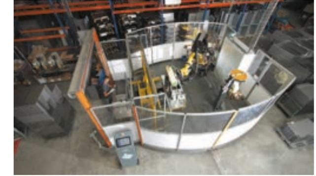
Cellule robotisée de soudure par points
