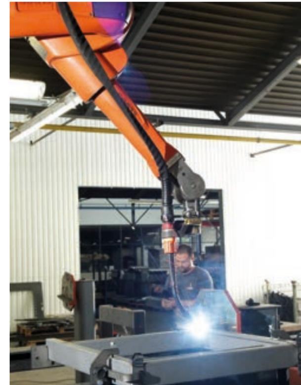
2 cellules robotisées de soudure semi-auto
